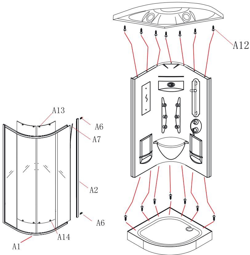
При монтаже стекол кабины, будьте внимательны! Не ставьте стекла на кафельный пол без защитного картона, избегайте ударов и падения стекол на угол!
