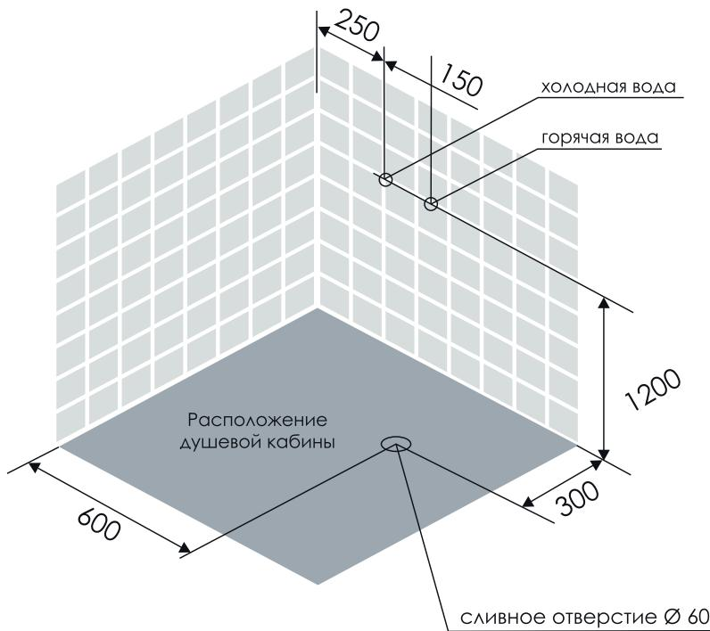
Выход электрического подключения не менее 500 мм над выводами воды
