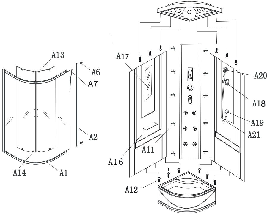
При монтаже стекол кабины, будьте внимательны! Не ставьте стекла на кафельный пол без защитного картона, избегайте ударов и падения стекол на угол!
