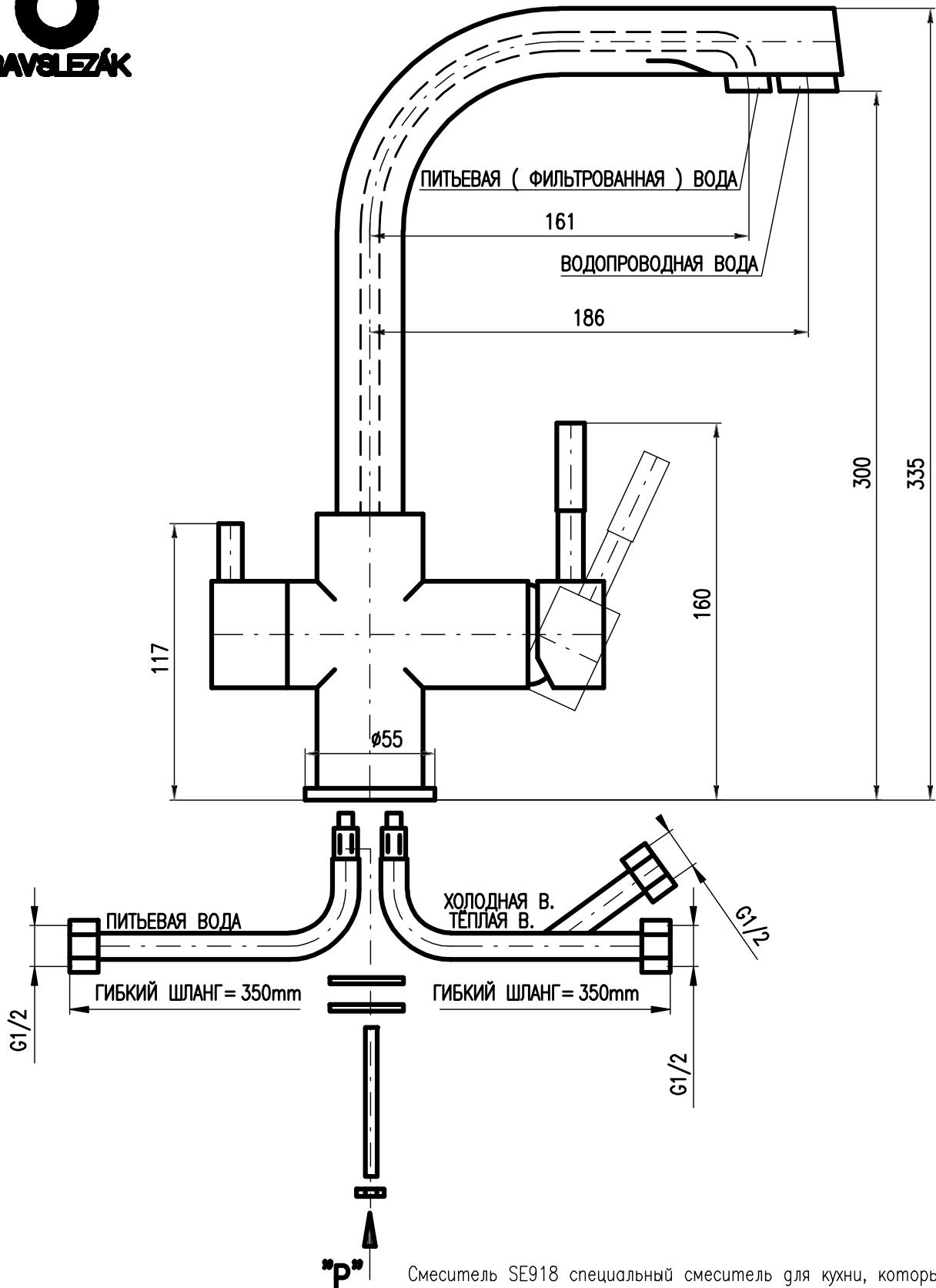
Смеситель SE918 специальный смеситель для кухни, который предоставляет возможность использовать в кухни два вида воды: фильтрованная (питьевая) и водопроводная вода. Фильтрованная вода – всегда только холодная.
