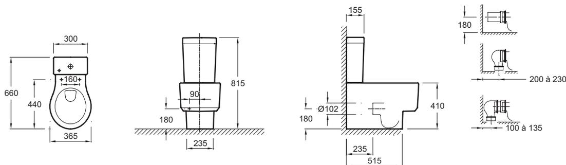
Спецификация продукта: Унитаз «vario» 66 x 36,5 см, устанавливаемый вплотную к стене. 4449K. Коллекция: VIRAGIO. Размеры (см): 66 x 36,5 см. Вес: 32 кг. В комплекте: крышка-сиденье с механизмом "плавное опускание" из термодюра 6472K, на металлических шарнирах.
