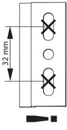
Befestigung der Aufhängeweisleisten mit 2 Schrauben!
