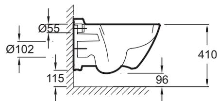
Спецификация продукта: Подвесной унитаз 55,5 x 38 см. E4440. Коллекция: PRESQU'ILE. Размеры (см): 55,5 x 38 см. Вес: 22,4 кг. В комплекте: эргономичная крышка-сиденье из термодюра E70016, металлические шарниры.
