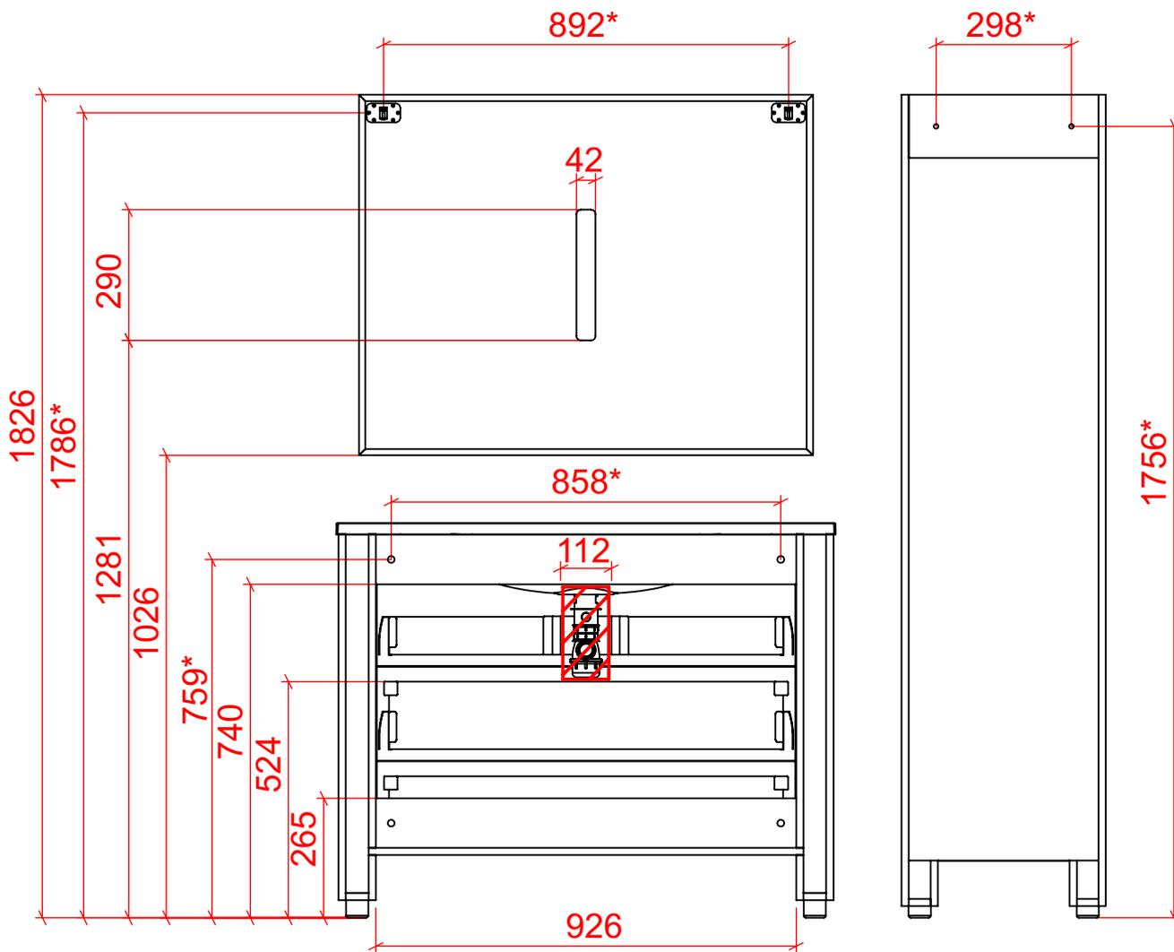
Рекомендуемая зона вывода коммуникаций заштрихована на чертеже. Расстояния от стены до задней стенки ящиков 32мм.
