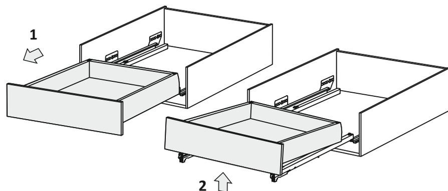
**Снятие ящика на скрытых направляющих**
