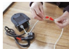
Подключение трансформатора Connection of the transformer
