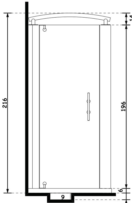
Alloggio pileta di scarico
