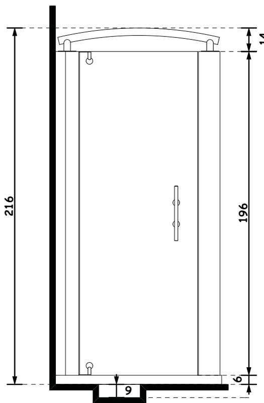
Alloggio piletta di scarico
